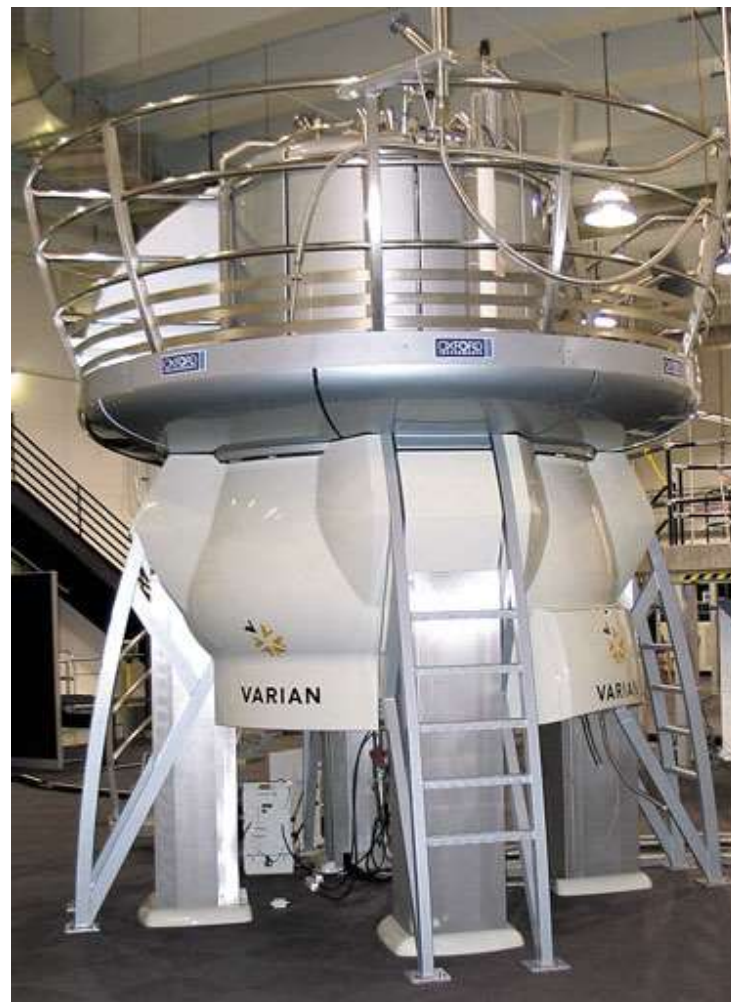
Магнит спектрометра Varian 900 МГц
